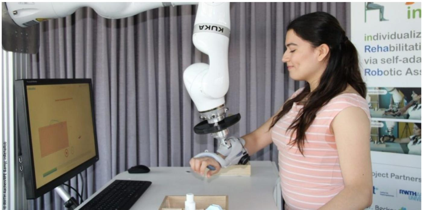
Roboter können helfen, nach einem Schlaganfall verlorene motorische Fähigkeiten wiederzuerlernen. Ein solches System wird zum Beispiel im inRehaRob-Projekt entwickelt.
