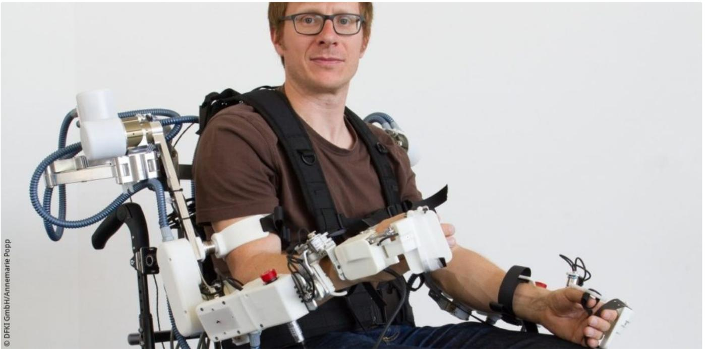
Das Teilsystem wird an einen Rollstuhl befestigt. Es umfasst die gesamte Kinematik des menschlichen Arms und unterstützt den Träger bei alltagsnahen Handlungen.
